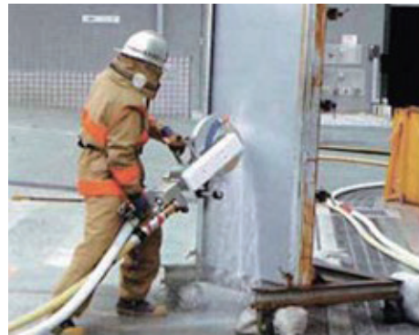
【消防防災科学技術研究推進制度の研究 成果（高圧水駆動カッター）】
